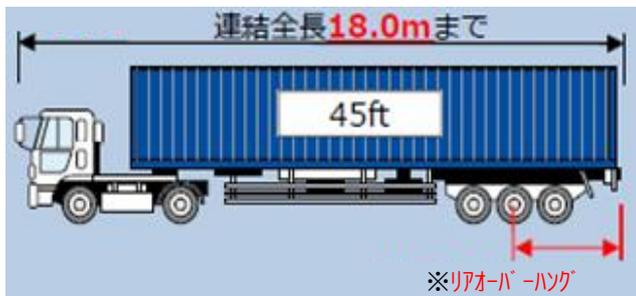
リアオーバーハングは、トレーラの旋回中心軸から車両後端までの長さをいいます。
